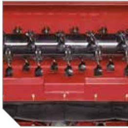
34 couteaux (17 paires) en "J", coupelles de protection des roulements de rotor, bavette caoutchouc flexible anti-projections.
