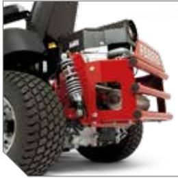
Suspension arrière avec amortisseurs à ressort et essieu avant pivotant avec amortisseurs de mouvement.
