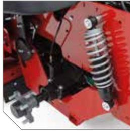
Système de suspension arrière avec amortisseurs indépendants et double transmission Hydro-Gear® ZT-3400® conçus pour des performances élevées.
