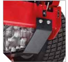
Protection de la transmission très robuste et étroite permettant un bon refroidissement et un accès facile au filtre à huile.
