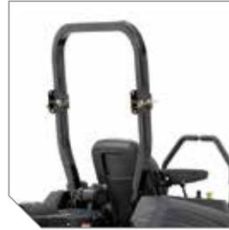
Arceau de sécurité repliable à 180° et ceinture rétractable.
