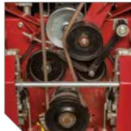
Enroulement de plus de 180° de la courroie sur la poulie d'entraînement principale pour garantir la transmission de puissance. Entraînement du rotor assuré par une courroie double, collée.
