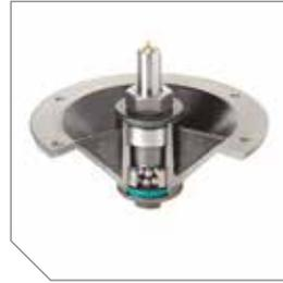
Fusées de tondeuse en fonte Hercules™ II avec roulements à billes industriels surdimensionnés, à contact angulaire et à double rangée de 62 mm, arbre de 30,16 mm et flasque de 257 mm à 6 boulons.
