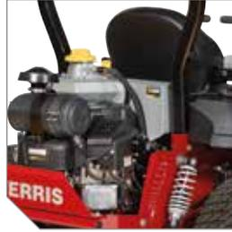
Les moteurs à injection électronique Vanguard® 810 cm³ avec système Oil Guard délivrent un niveau de puissance optimal tout en consommant peu et en assurant des durées et coûts d'entretien réduits.
