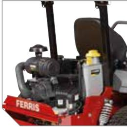
Le moteur à injection électronique BIG BLOCK™ Vanguard® 993 cm<sup>3</sup> avec système Oil Guard donne un niveau de puissance optimal tout en consommant peu et en assurant des durées et coûts d'entretien réduits.
