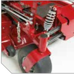
Nouvelle génération de suspensions avant avec 4 bras de suspensions offrant un confort accru et permettant à l'avant de la tondeuse de suivre les contours de la pelouse.
