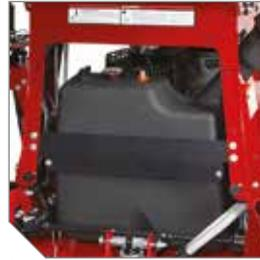
Le grand réservoir à carburant de 23 litres est centré afin de garantir un bon équilibre et la tubulure de remplissage est judicieusement placée sur le flanc pour un accès aisé.
