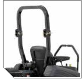
Arceau de sécurité ROPS repliable à 180° et ceinture de sécurité rétractable.
