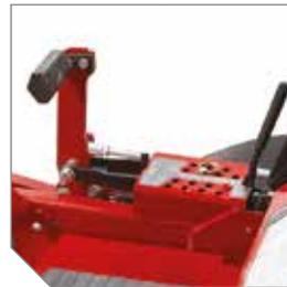
Le système de levage hydraulique du plateau de coupe permet de le lever et de l'abaisser sans effort.
