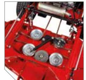
Cinématique du système de courroie étudiée avec le plus grand soin pour assurer une tension de courroies optimum, une fiabilité, et une longue durée de vie.
