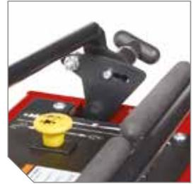
Le réglage de commande de vitesse à 3 positions doté d'un verrouillage aisé est bien positionné et son utilisation ne nécessite aucun outil afin de faciliter le fonctionnement dans une grande diversité de conditions.
