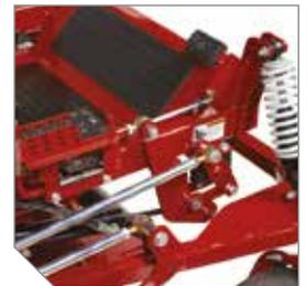
Commande de relevage hydraulique du plateau de coupe actionnée par une pédale pour assurer une manœuvre sans effort.
