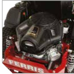
Le moteur Briggs & Stratton® Commercial Series™ est doté d'un système de filtration des poussières et de particules fines à cinq étapes équipé d'un filtre à air cyclonique.
