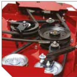
L'ISX™ 800 est équipé d'un système d'entraînement du plateau à 2 courroies qui améliore la durée de vie des courroies, est plus fiable et offre une garantie limitée de 3 ans (voir le manuel de l'opérateur pour plus de détails sur la garantie).
