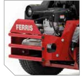
Robustes renforts arrière protégeant le moteur et permettant également un accès facile pour la maintenance.
