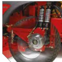
Double suspension arrière à ressort avec système de réglage pour obtenir plus ou moins de souplesse.
