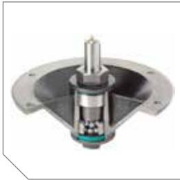
Boîtier en fonte de 257 mm de diamètre, 6 trous de fixation, arbre de sortie diamètre 30,16 mm, roulement conique de 62 mm de diamètre avec double rangée de billes, étanchéité par bague à double lèvre, bouclier métal; et possibilité de graissage par le haut du palier.
