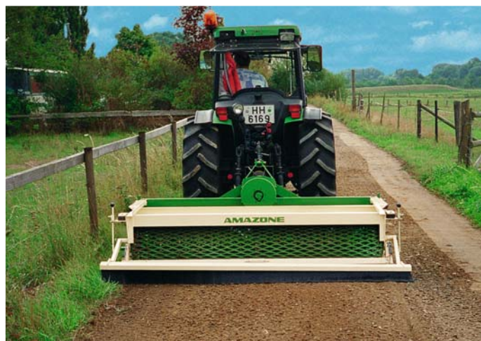
Rénovation des chemins de randonnée et simultanément lutte mécanique contre les mauvaises herbes avec la herse alternative
