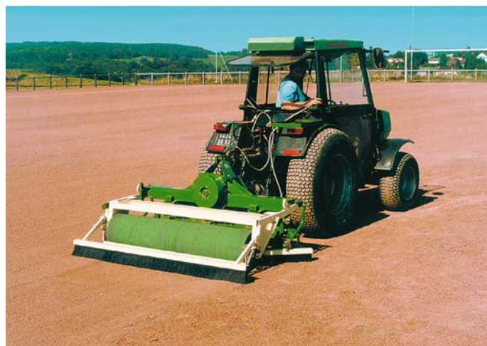
La herse alternative assure un nivelage des inégalités du sol
